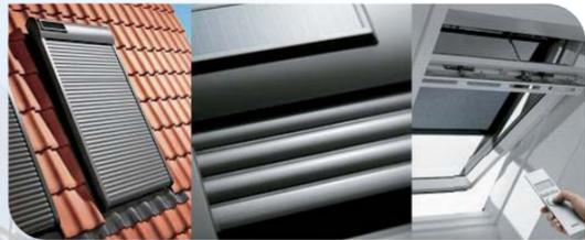
창문 외각 커버에 부착된 태양 전지 패널로부터 모아진 에너지는 배터리 박스에 저장되고, 리모컨을 이용해 창문을 작동하는 전원으로 사용된다. 작동 모터와 배터리 박스는 공장에서 밀봉되어 제작되며, 한번 충전된 모터는 약 300회의 창문 개폐 (open and shut)를 가능하게 한다. 배터리의 충전은 맑은 날 뿐만 아니라 흐린 날에도 가능하며, 배터리 박스에 충전된 에너지는 다음 사용을 위해 저장되므로 지속적인 창문 작동을 가능하게 해 준다. 또한 Velux는 Io-Homecontrol<sup>2)</sup> 기술을 도입하여 하나의 리모컨으로 다른 제품군도 함께 작동할 수 있도록 편리성을 제공하였다.
